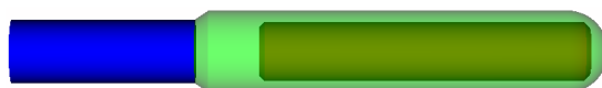
Rysunek 2.19: Trójwymiarowa wizualizacja modelu źródła micrSelectron-HDR ^{192}\text{Ir} v2, według listingu 2.4. Półprzezroczysta, zielona osłona ze stali AISI 316L okrywa czerwony, irydowy rdzeń. Kolory dobrano w celach prezentacyjnych. Por. rys. 2.7.
