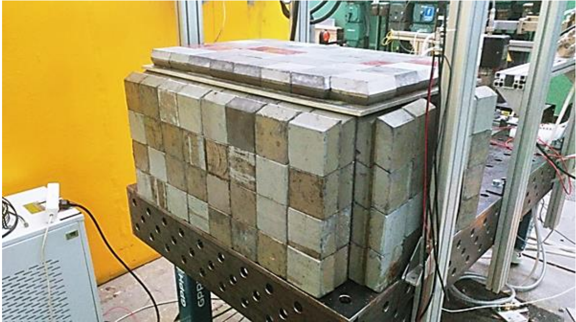
Rys. 54 - Osłony przed promieniowaniem gamma (widok na tylną ścianę domku ołowianego)
