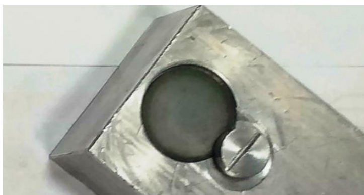
Rys. 51 – Tarcza spiekana umieszczona na uchwycie
