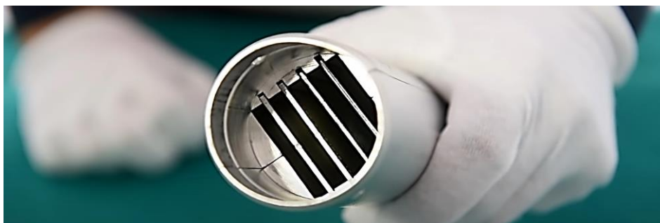
Rys. 5 - Tarcze uranowe w zasobniku do napromieniowywania w reaktorze MARIA [18]
