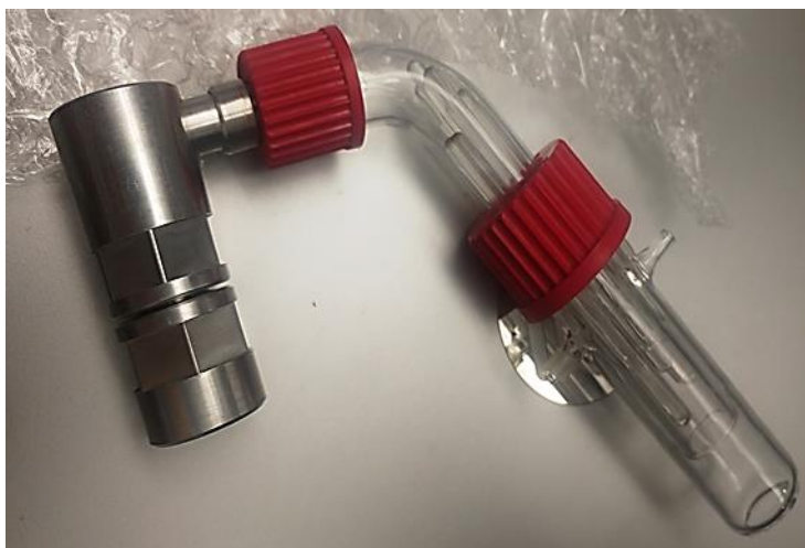
Rys. 72 - Tarcza podłączona do odbiornika ciepła sublimatora
